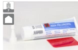
**Einsatzbereiche:** Für feine Risse und offene Fugen bei unbehandelten/grundierten Echtholz-, Laminat-, MDF-, und Metalloberflächen wie z.B. Fensterprofilen. Schadstelle mit Überstand befüllen und nach Aushärtung mit Schleifpapier oder Lackhobel plan arbeiten.
